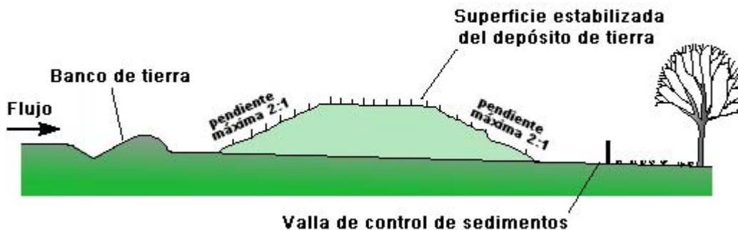
Se debe asignar un espacio para la entrega y descarga de materiales. Se mantendrán los depósitos de tierra alejados de la entrada a la zona de obras, evitándose así la descarga de sedimentos hacia el sistema de canalización de aguas de tormenta.
